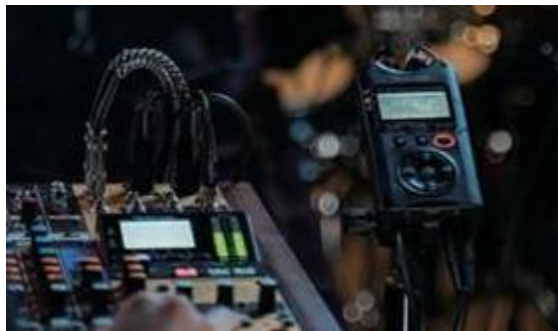
DR-40X 4トラックデジタルオーディオレコーダー/ USBオーディオインターフェース
