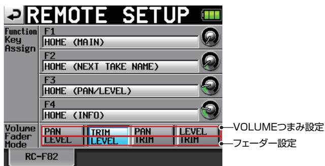
“Volume Fader Mode” 項目に表示されているボタンを選択します。ボタン内の上側がVOLUMEつまみ、下側がフェーダーに割り当てられる設定です。
